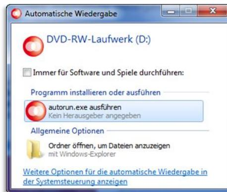
Falls dies nicht der Fall sein sollte, können Sie die Installation auch manuell starten, indem Sie die autorun.exe auf der CGM DMP-ASSIST-DVD ausführen. Sie können weiterhin über **[Start bzw. Ausführen]** den Pfad des Setup-Programms direkt eingeben:
