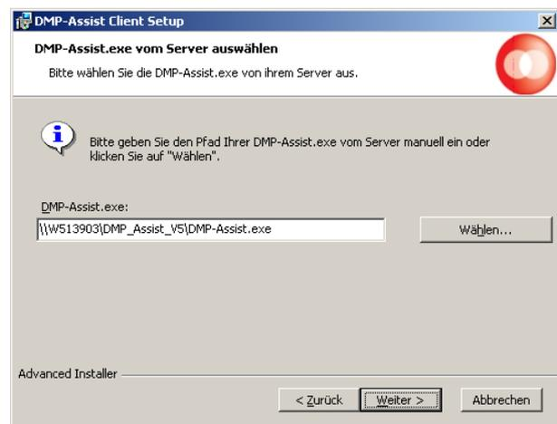
Im Installationsassistent wird im Idealfall die Netzlaufwerkverknüpfung zur DMP-Assist.exe angezeigt. Sollte der Pfad zur DMP-Assist.exe NICHT angezeigt werden, so stellen Sie hier bitte über **[Wählen]** den korrekten Pfad zur DMP-Assist.exe auf dem Server ein. Bestätigen Sie dann bitte ebenfalls mit **[Weiter]**.
